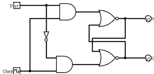
Quando il segnale di clock arriva al falling-edge,  $D$  deve essere valido per evitare di memorizzare un stato errato.
