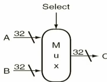
Un multiplexor con un bus a 32bit corrisponde ad un array di 32 multiplexor ad 1bit.
